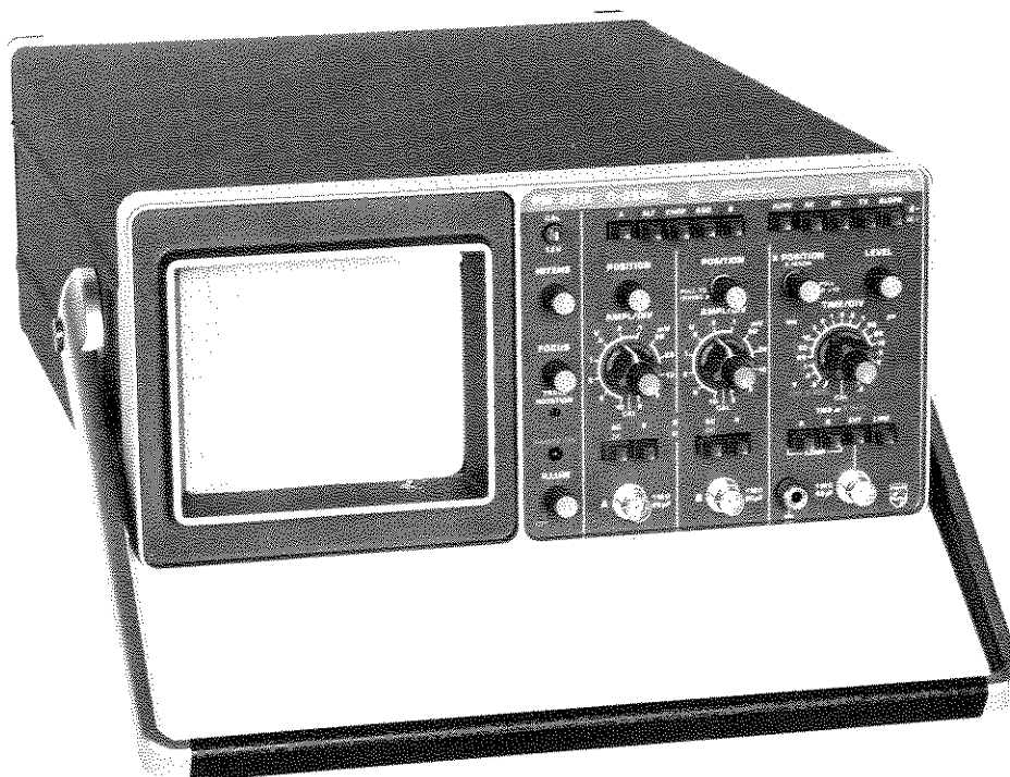
Abb. 1.1. 25 MHz Zweikanal-Oszilloskop PM 3212
