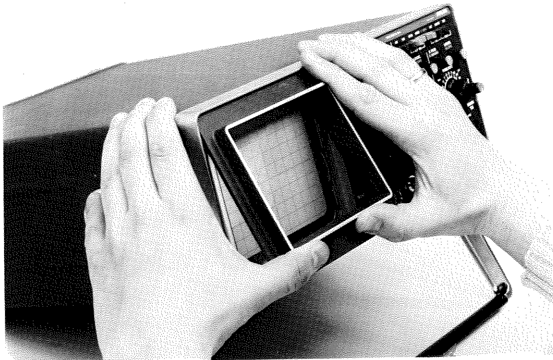
Fig. 2.9. Dépose de la visière et de la plaque de contraste
