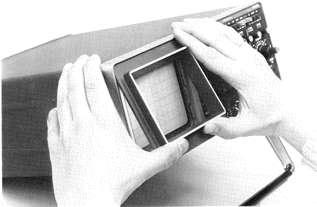
Abb. 2.9. Abnehmen des Bildröhrenrahmens und der Kontrastplatte.
